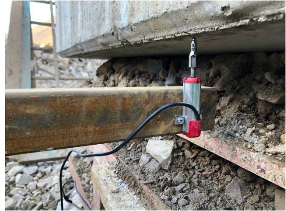
Şekil 3. Kesme kutusu deformasyonunu takip etmek için kullanılan yatay ve düşey potansiyometrik cetvellerden görünüm
