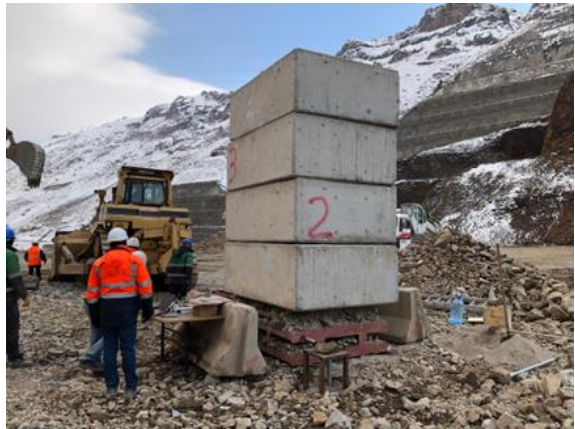
Şekil 2. Farklı efektif gerilmeler altında deney hazır düzeneklerden görüntüler
