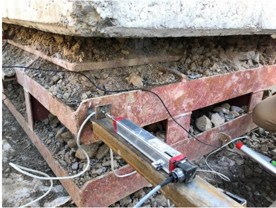
Şekil 3. Kesme kutusu deformasyonunu takip etmek için kullanılan yatay ve düşey potansiyometrik cetvellerden görünüm
