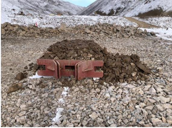
Şekil 1. Çerçeve içerisi ve çevresinde numune serimi ve standart sıkıştırma işlemi
