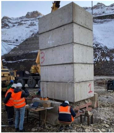
Şekil 2. Farklı efektif gerilmeler altında deney hazır düzeneklerden görüntüler
