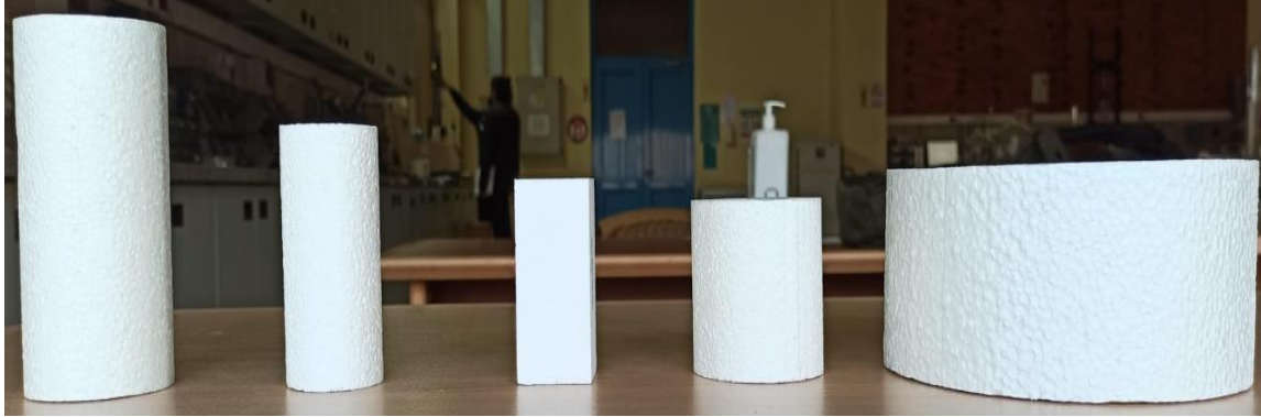
Şekil 4. Çalışma kapsamında kullanılan farklı boyutlarda ve yoğunlukta silindirik ve dikdörtgen numuneler
