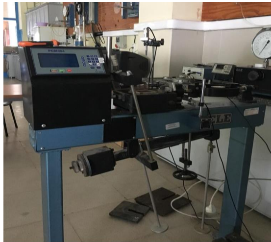
Şekil 1. Küçük ölçekli direkt kesme kutusu deney aleti
