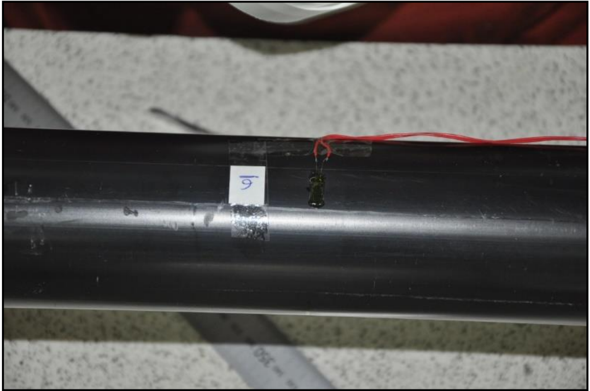
Şekil 2. Boruda gerilme ölçümünde kullanılan gerinim pulu (strain gauge)
