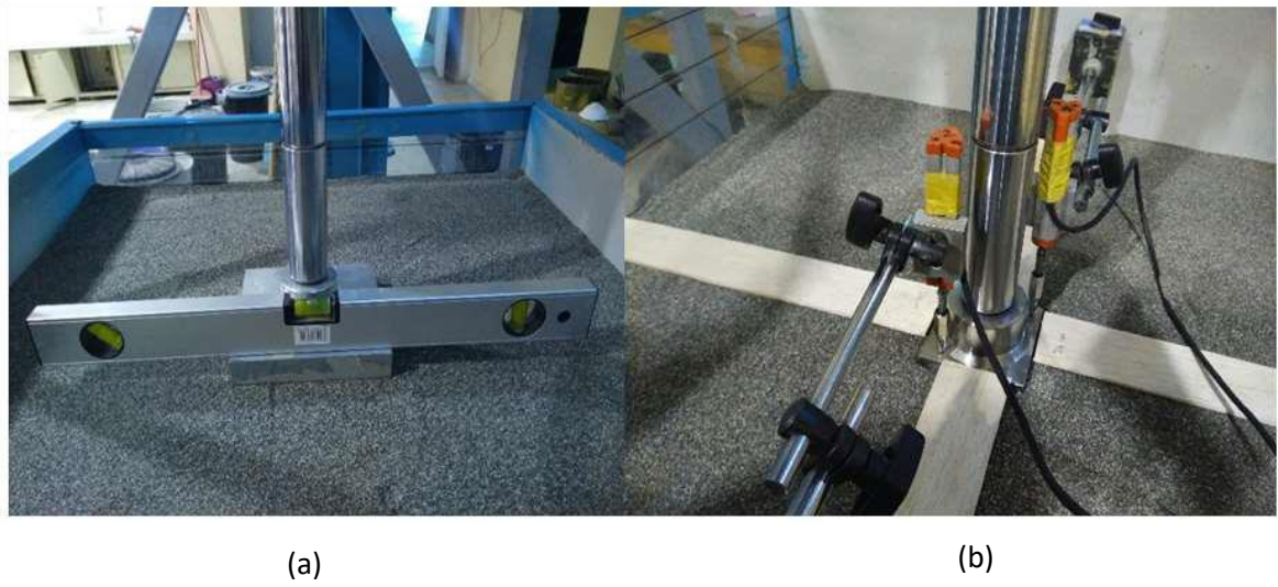
Şekil 2. (a) Model temellerin deney tankına yerleştirilmesi, (b) Düşey yükleme
