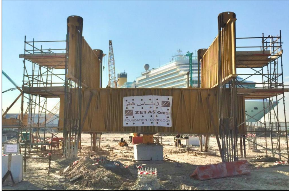
Şekil 6. Kazık yükleme testi düzeneği
