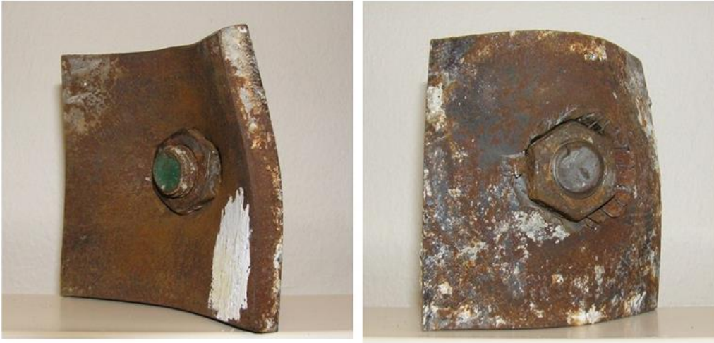
Şekil 3. Sahada basınç altında yenilen düz bulon plakalarının ön ve arka yüzleri (Li, 2017)
