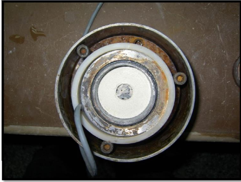
Şekil 4. Kil numunesinin ortasında çakıl kolonla teşkil edilmiş hali
