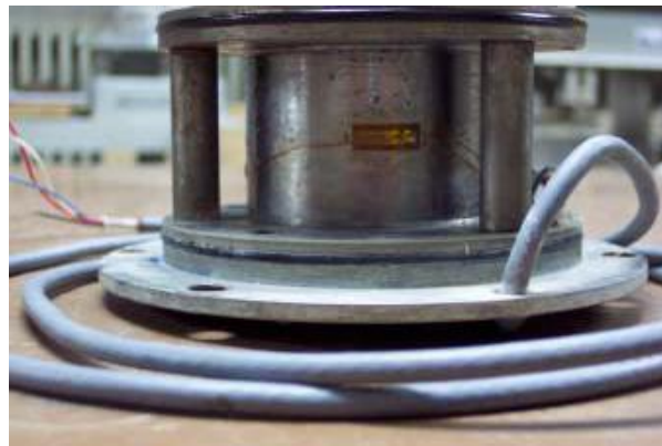
Şekil 2. İnce cidarlı ödometre gövdesinde konumlu gerinim ölçer ve veri toplama kablosu
