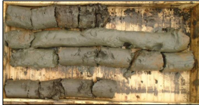
Şekil 3. İlgili bölgede yer alan kil tabakaları için örnek sandık fotoğrafı
