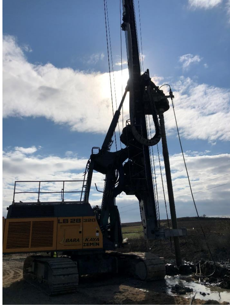
Şekil 2. Kullanılan derin karıştırma ekipmanı
