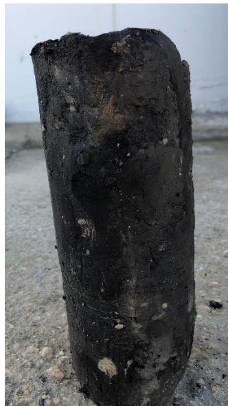
Şekil 6. Organik zeminlerden alınan derin karıştırma numunesi
