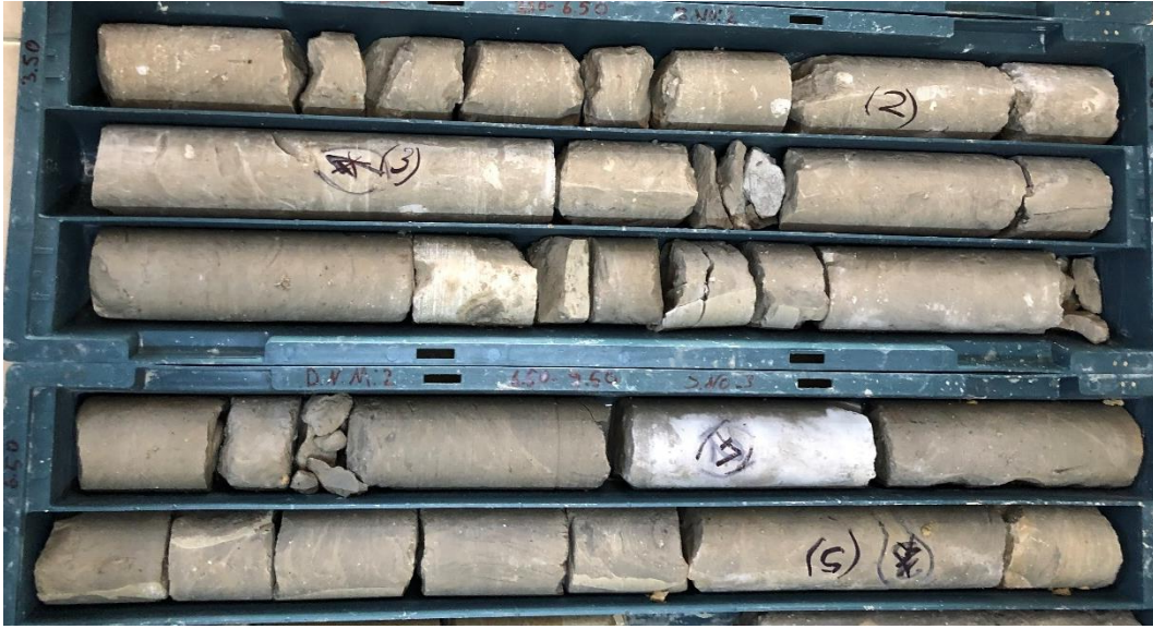
Şekil 4. Siltli killi kum tabakalarından alınan derin karıştırma numuneleri
