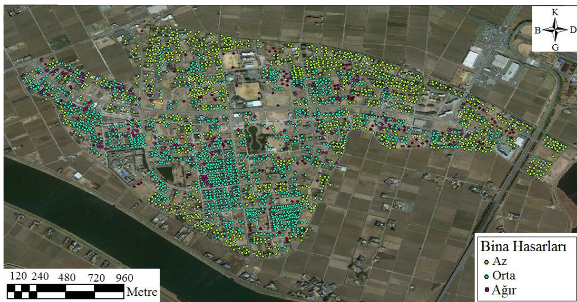
Şekil 6. Hinode bölgesi bina hasarları
