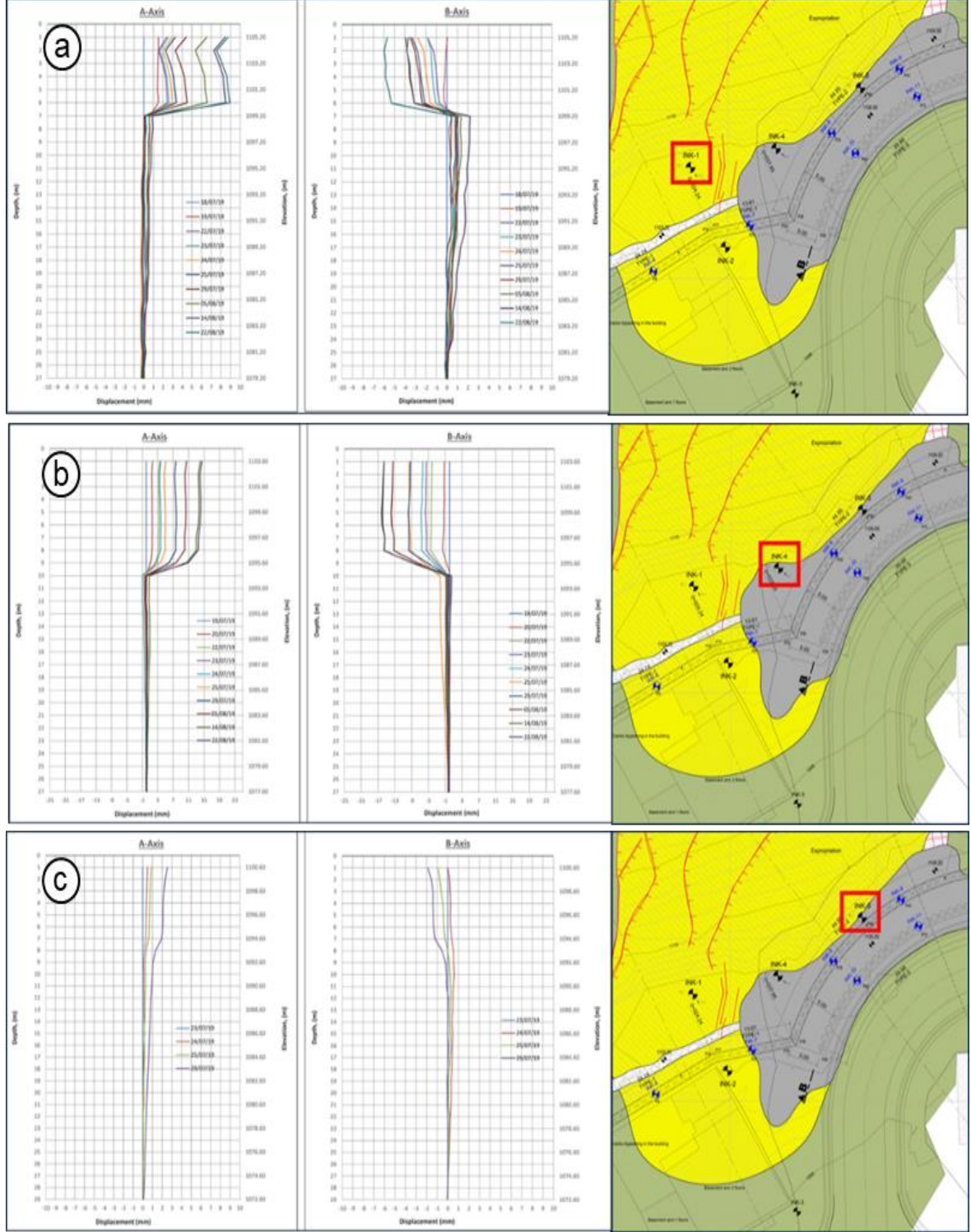
Şekil 4. Bouerej heyelanı inklinometre yerleri ve ölçüm grafikleri.
