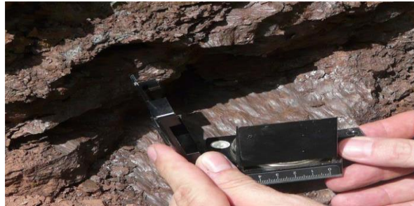
Şekil 1. Killeşen kayma düzleminde ara yüzeye ait örnek bir görünüm (Alonso ve Pinyol, 2014)
