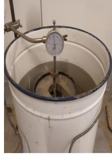
Şekil 10. Cüruflara ait şişme – zaman grafiği ve numune doyurma kabı
